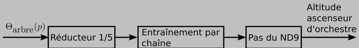
Figure 23 : transmission à la sortie du moteur
