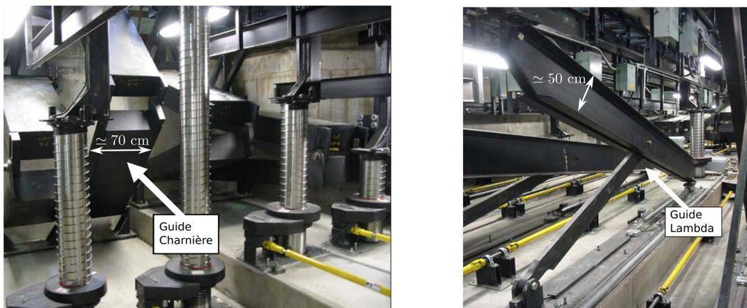
Figure 10 : éléments de guidage d'une plate-forme
